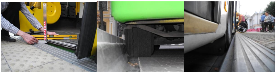
Рисунок 4.15 – Рівень Кассельського бордюру з рівнем транспорту
