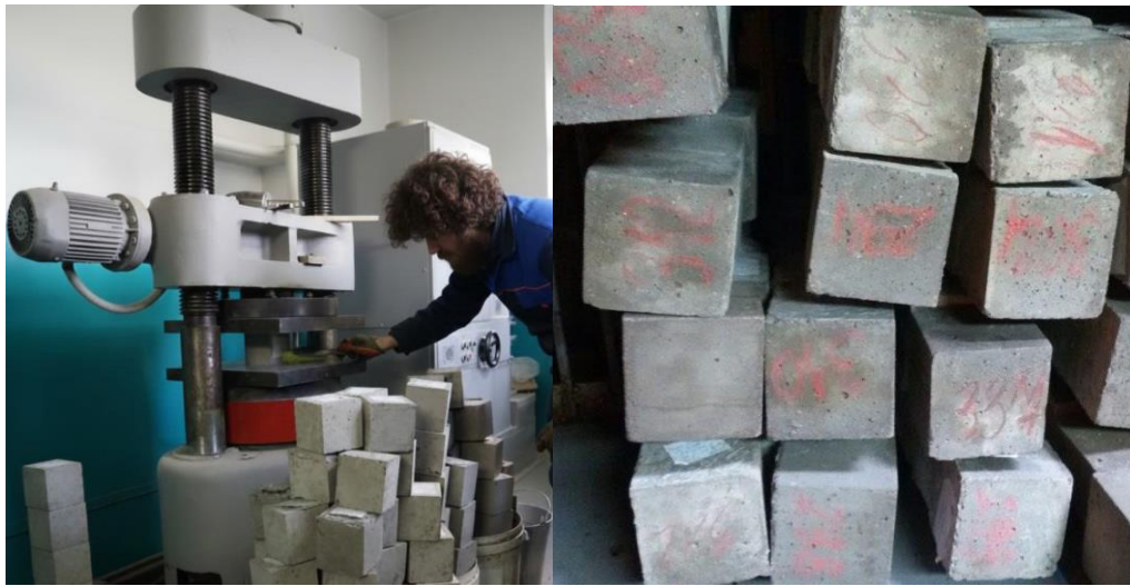
Рисунок 4.7 – Пресс П–125, для випробовування зразків–кубиків на стиск
